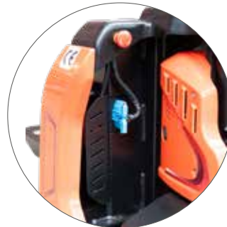
Akkuanschluss mit Not-Aus-Knopf
