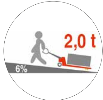
6% Steigfähigkeit bei Volllast
